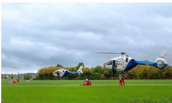
Ein Heli nimmt Last auf, der zweite ein Bambi Bucket, einen faltbaren Wasserbehälter. – Ein Tango weist seinen Fox ein.
