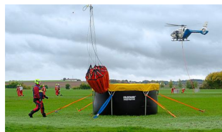
Ein Semat wird angehängt. Mit diesem Behälter kann man Waldbrände löschen. – Ein Bambi versucht Wasser zu schöpfen.
